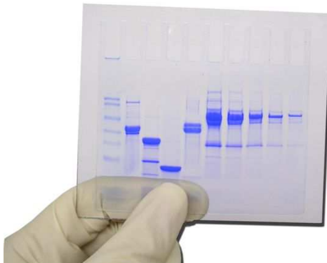
Figure 3 : Photo d'un gel UltraPaq® après migration et coloration de protéines
